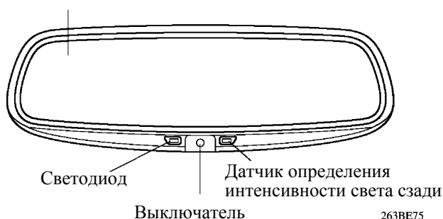
Электрохромная ячейка зеркала
